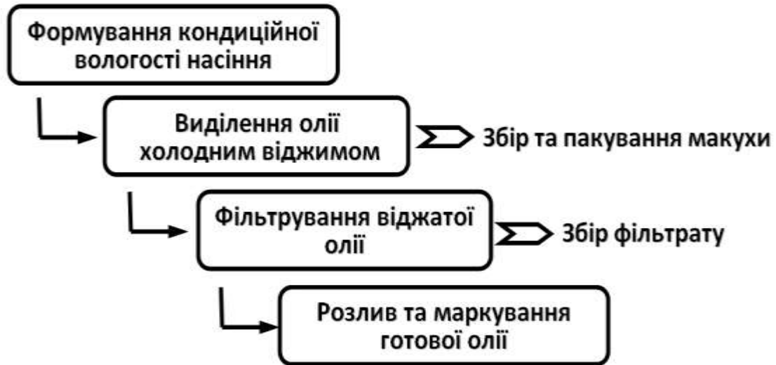
Рис. 8 – Технологічна схема одержання конопляної олії
