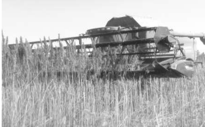
Рис. 1 – Загальний вигляд збирання насіння конопель зернозбиральним комбайном
