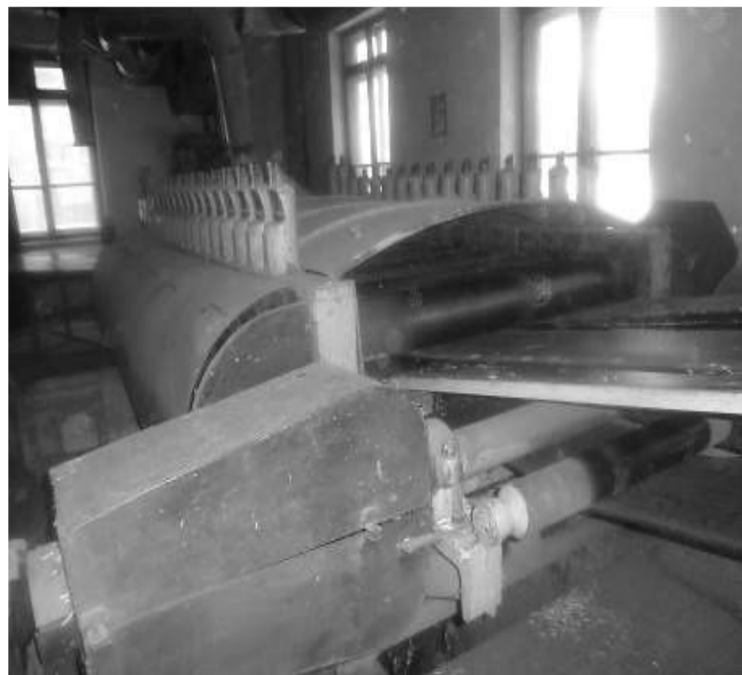
Рис. 3 – Загальний вигляд м'яльно-тіпального агрегату (МТА) для вироблення довгого волокна конопель (а) та м'яльної машини ПМГ-1 (б)
